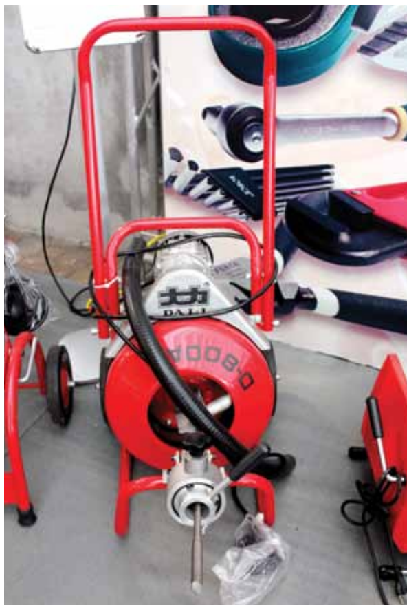
La máquina destaqueadora de Capris, ideal para hoteles, se adapta a tuberías que van desde 32 mm a 100 mm de diámetro
